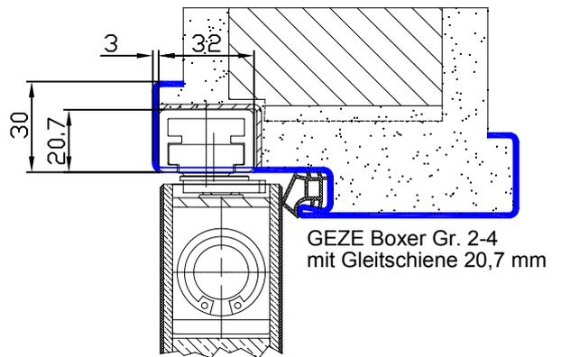
Bei Bestellungen ohne Angabe der Typenbezeichnung für die Gleitschiene, werden die Zargen standardmäßig für die kleine Gleitschiene vorgerichtet. Befestigung der Gleitschiene bauseits.
