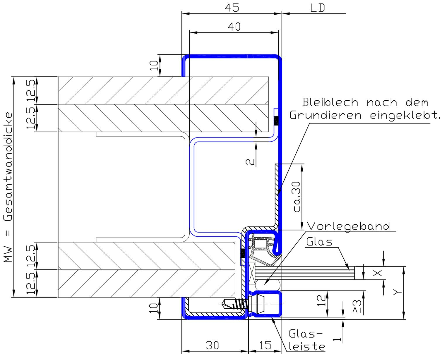
Zum Schutz des Bleibleches vor aggressiven Hinterfüllstoffen, muss dieses vor der Zargenmontage mit einem entsprechenden Schutzanstrich versehen werden !
