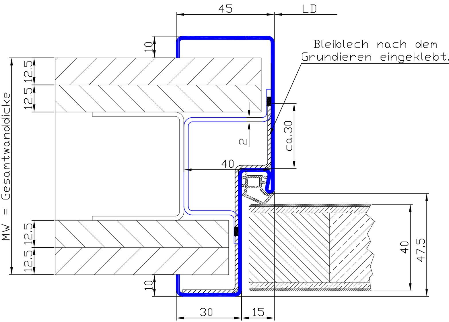
Zum Schutz des Bleibleches vor aggressiven Hinterfüllstoffen, muss dieses vor der Zargenmontage mit einem entsprechenden Schutzanstrich versehen werden !
