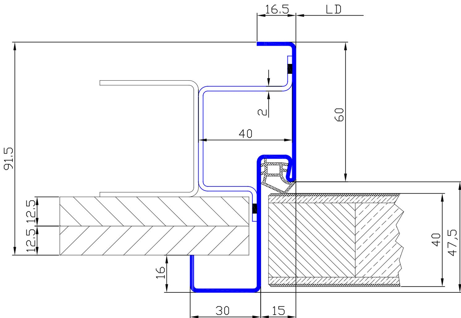
Montage mit selbstschneidenden Schrauben  $\varnothing$  6,3 mm.
