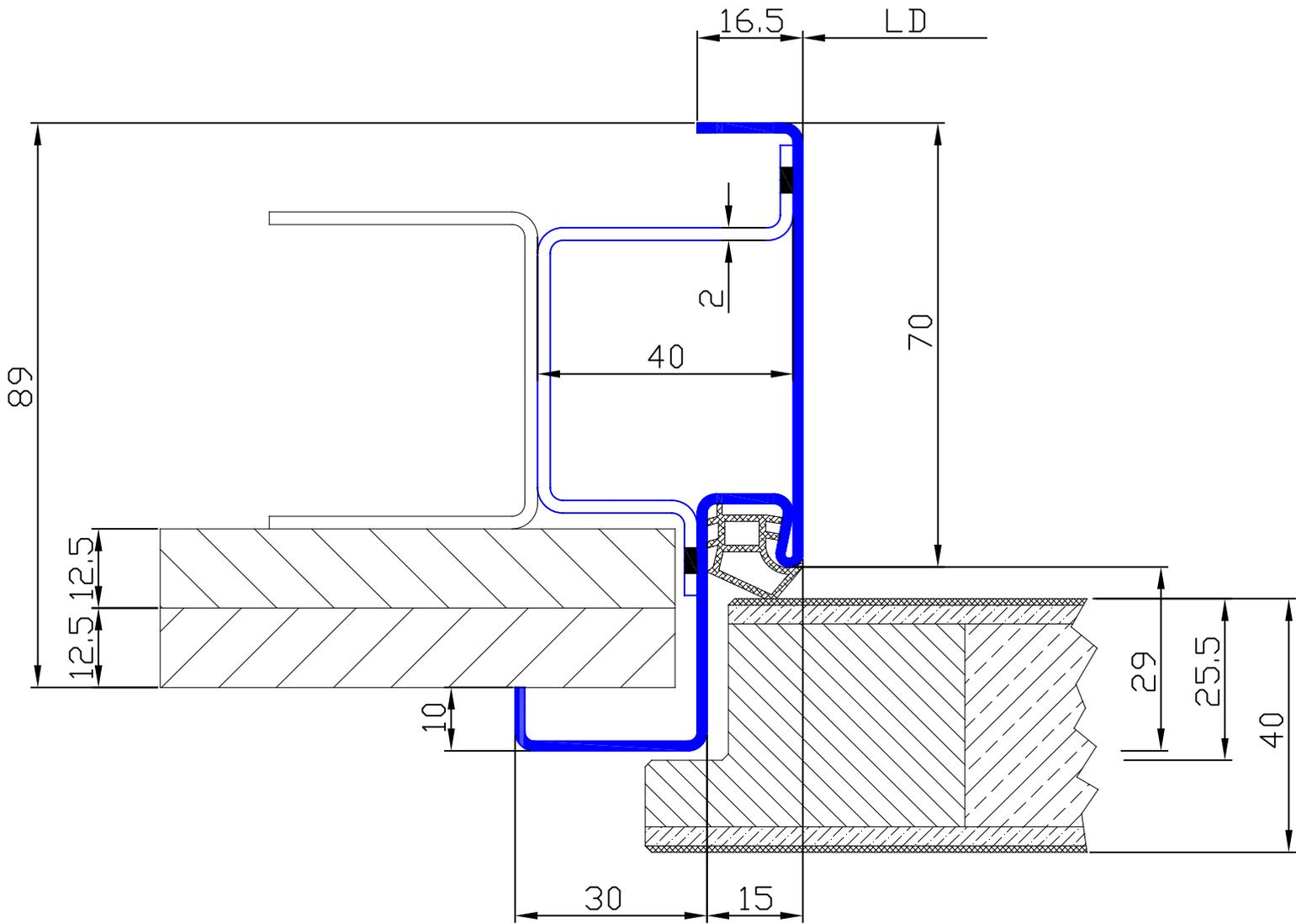
Montage mit selbstschneidenden Schrauben  $\varnothing$  6,3 mm.
