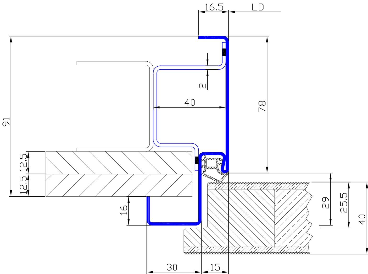
Montage mit selbstschneidenden Schrauben  $\varnothing$  6,3 mm.
