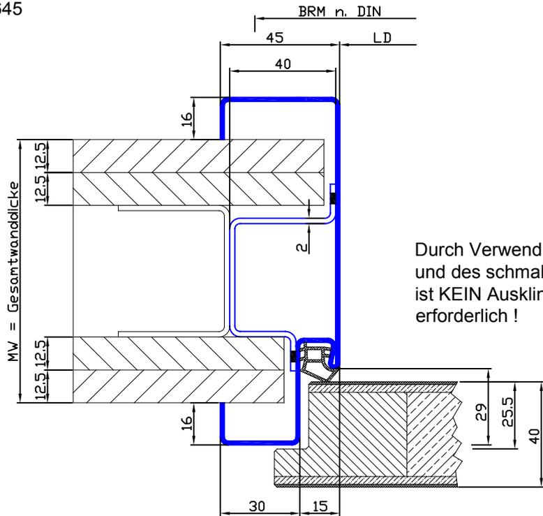
Durch Verwendung der BUK V8618 und des schmalen Mauerstuttkasten ist KEIN Ausklinken der Gipskartonplatte erforderlich !
