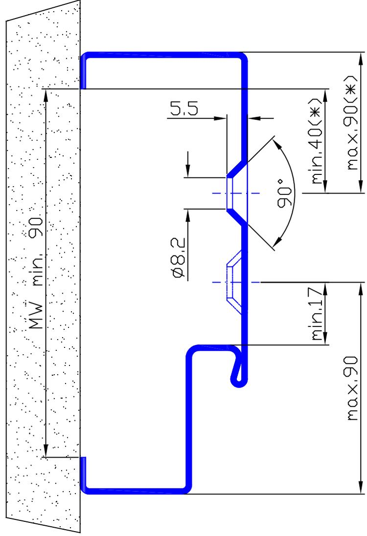
(\*): Maß 40 nur für Sichtmauerwerk, bei Putzmauerwerk ist ein größeres Maß zu wählen.
