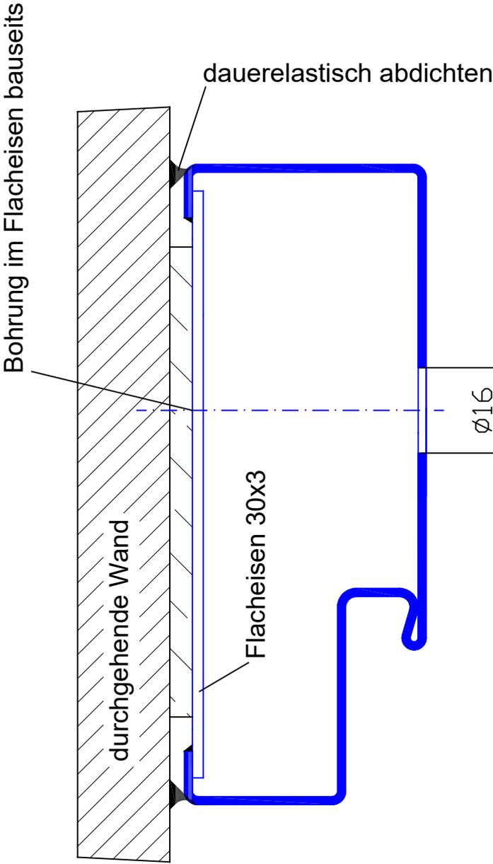
Der Flacheisenanker ist gegen Durchbiegung druckfest zu unterfüttern (z.B. durch unterlegen von Holz)
