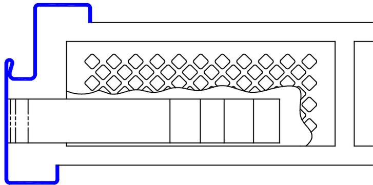
Wo es die Spiegelvariante nicht zulässt, dass Ruck-Zuck-Anker eingesetzt werden (z.B. Schattennut, Rundspiegel), werden die Zargen mit Wellankern (2 Stück je Seite) ausgestattet.
