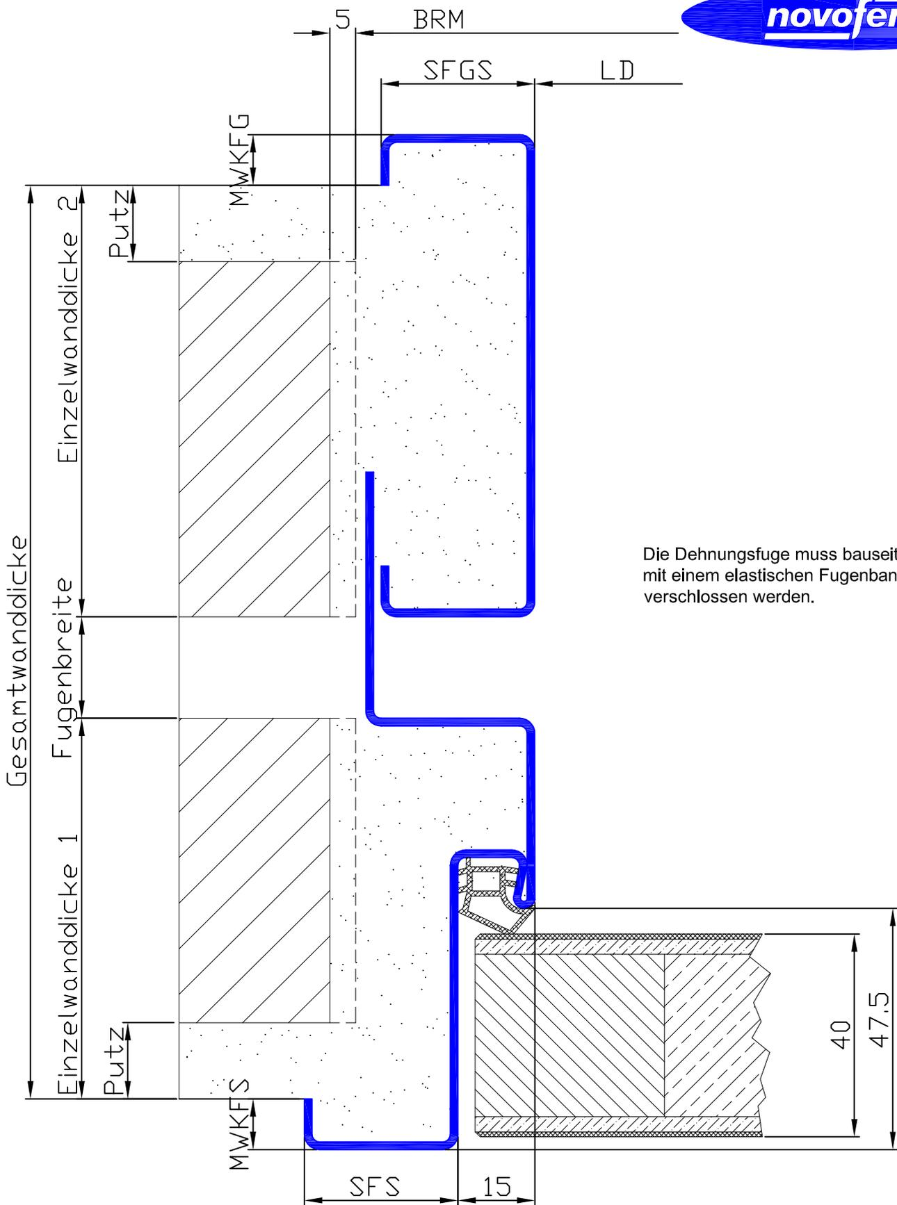
Die Dehnungsfuge muss bauseits mit einem elastischen Fugenband verschlossen werden.
