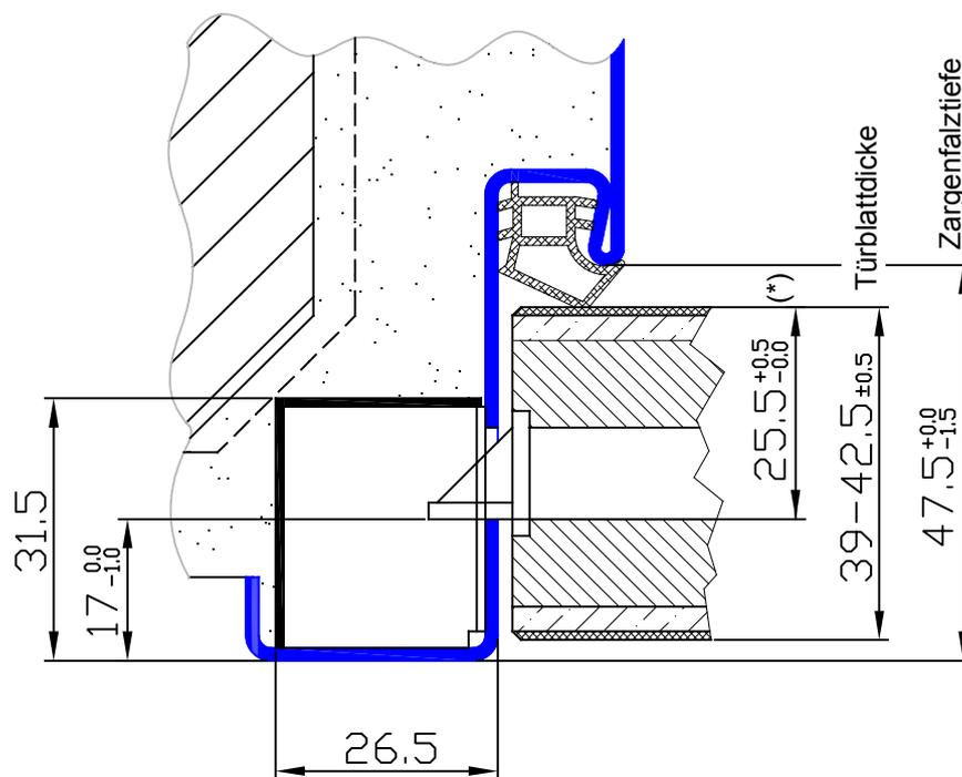
(\*) Bei Normalfälzung 25,5 mm bzw. bei Türblattdicke 39 mm
