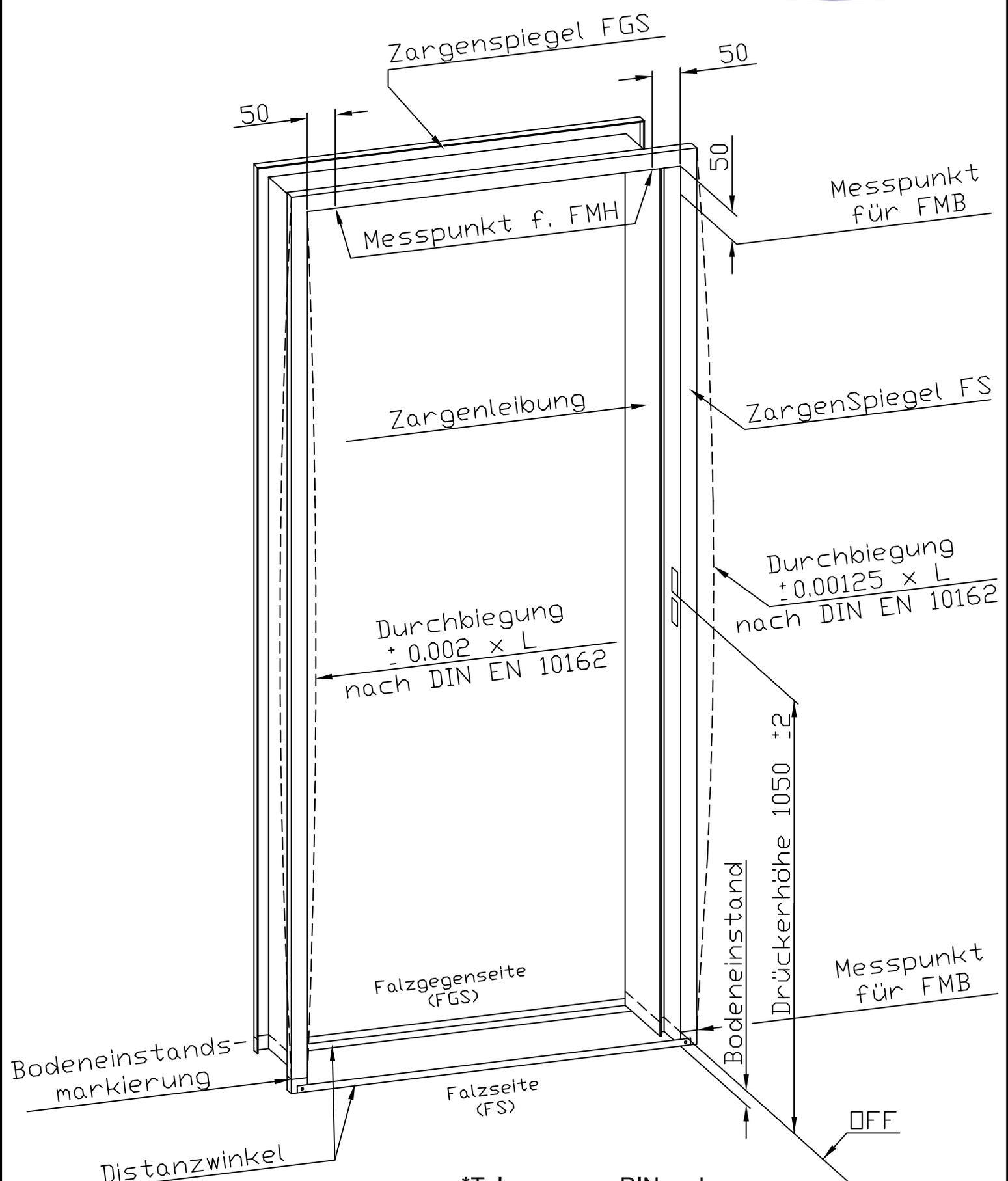
\*Toleranzen n. DIN und Novoform-Werksnorm gelten für die Fertigung bzw. für die Lieferform von Normzargen.
